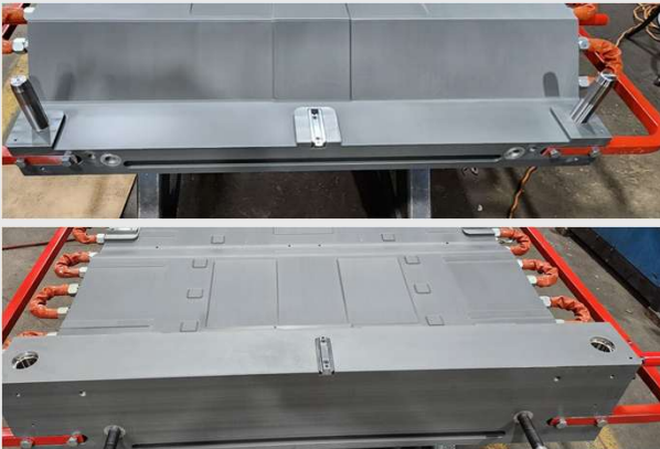
60" x 45" precision 5-axis machining
